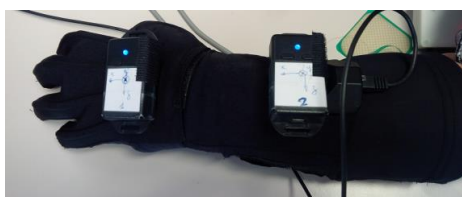
Figura 3: Guante sensorizado y sensores inerciales
